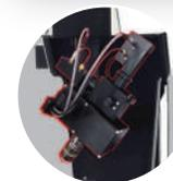
**Smart 定制化多光子显微镜**配备电动倾斜模块, 通过旋转物镜能以更高的自由度在不同角度观察样品。
